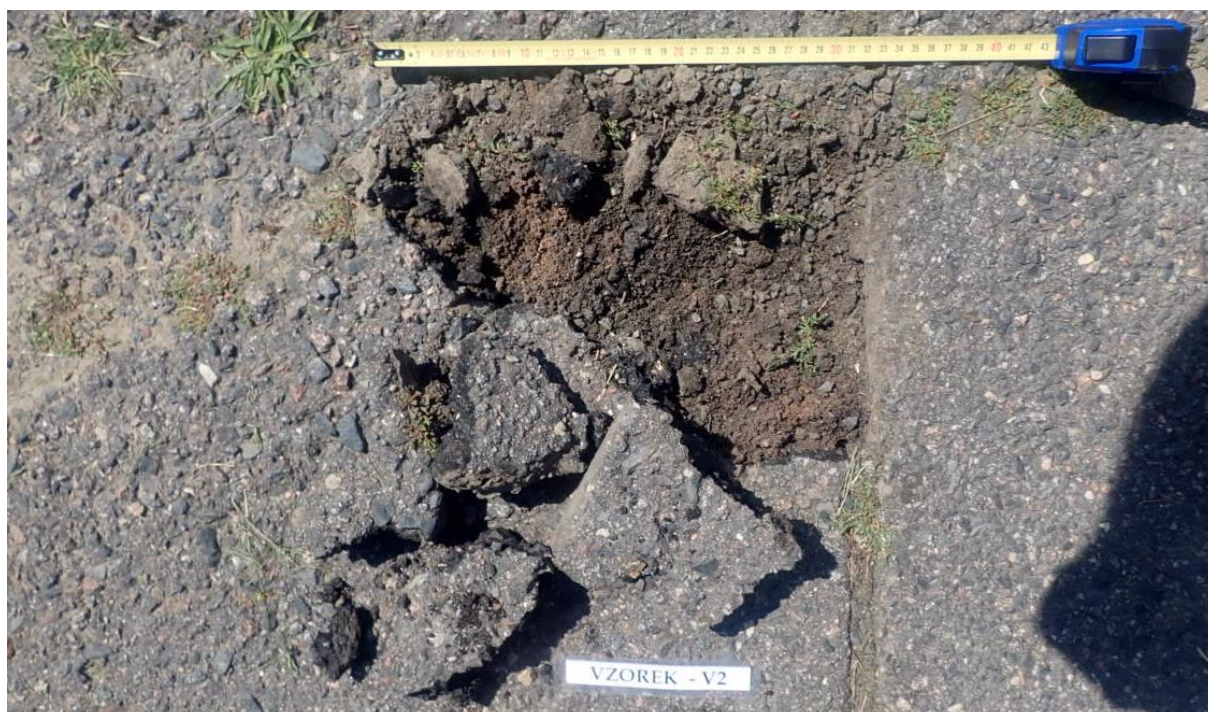
Obr. 3 - Jádru vývrtu Vzorek – V2 (in situ).
