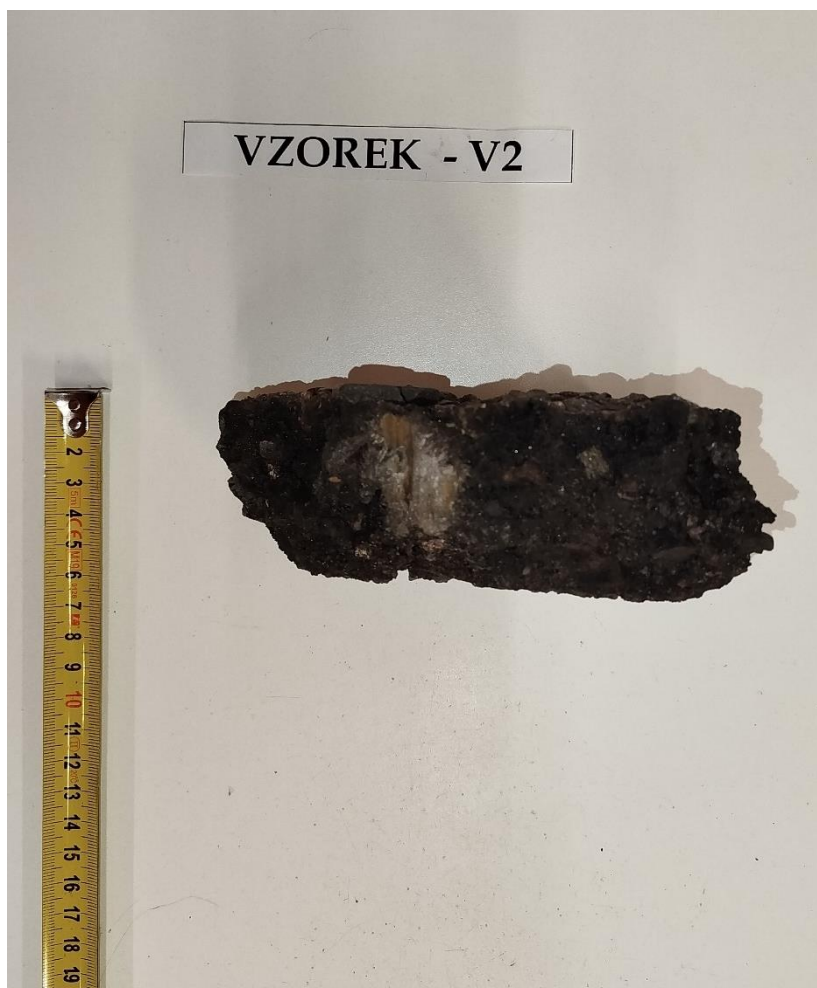
Obr. 4 - Jádru vývrtu Vzorek – V2 (laboratoř).
