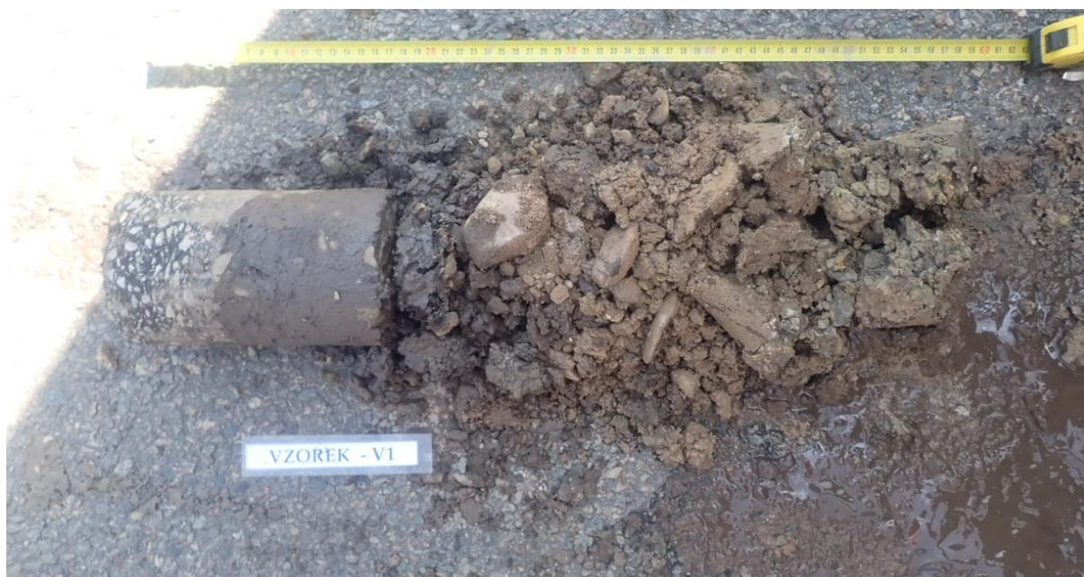
Obr. 1 - Jádro vývrtu Vzorek – V1 (in situ).
